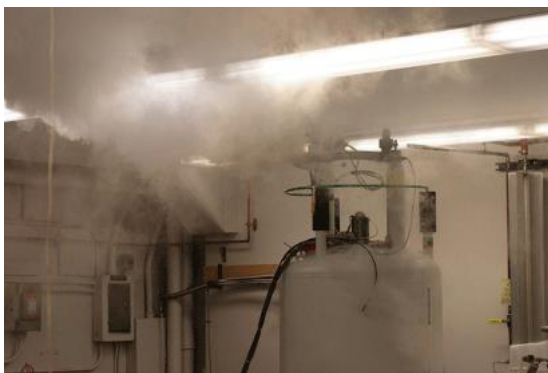
Figure 5: Vaporisation d'hélium due au quench d'un appareil RMN 20
